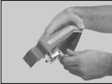
(D) Remove the Blade Guard Intake Fitting
