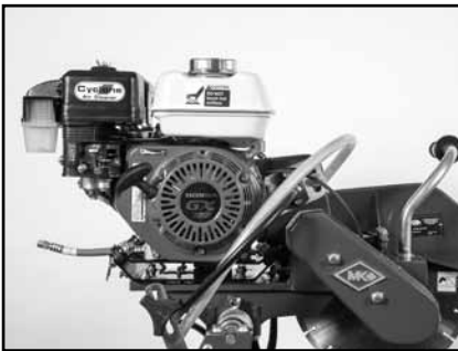
(D) Inspect Engine for leaks.
