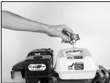
(D) Install Fuel Cap. DO NOT over-tighten.
