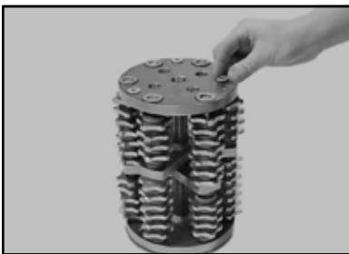
(D) If present, remove the three Flat Washer Spacers.
