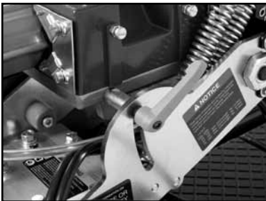
(D) Loosen the Cutting Head Height Lock.
