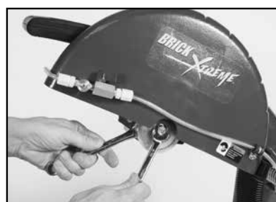
(D) Install retaining screw and Outer Flange - tighten.
