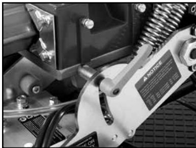
(D) Loosen the Cutting Head Height Lock.
