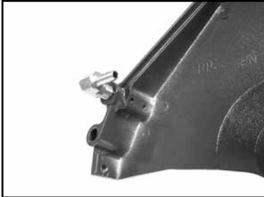
(D) Remove the Blade Guard Intake Fitting.
