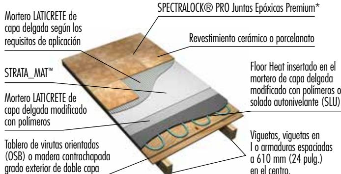
**INSTALACIÓN DE REVESTIMIENTO CERÁMICO O PORCELANATO SOBRE STRATA\_MAT™ EN PISOS VINÍLICOS SOBRE MADERA CONTRACHAPADA GRADO EXTERIOR O TABLERO DE VIRUTAS ORIENTADAS DE UNA SOLA CAPA.**
