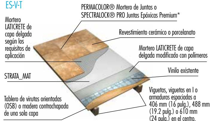
**INSTALACIÓN DE PIEDRA O PIEDRA SENSIBLE A LA HUMEDAD SOBRE STRATA\_MAT™ CON MADERA CONTRACHAPADA GRADO EXTERIOR O TABLERO DE VIRUTAS ORIENTADAS DE DOBLE CAPA.**
