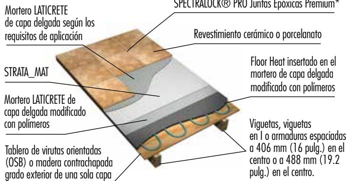
**INSTALACIÓN DE REVESTIMIENTO CERÁMICO O PORCELANATO SOBRE STRATA\_MAT CON FLOOR HEAT EN TABLERO DE VIRUTAS ORIENTADAS O MADERA CONTRACHAPADA GRADO EXTERIOR DE DOBLE CAPA, CON VIGUETAS, ARMADURAS O VIGUETAS EN I ESPACIADAS A 610 MM (24 PULG.) EN EL CENTRO.**
