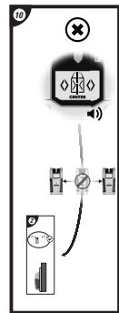
**8** Skjut Stud Sensor 200 saktat över ytan i en rak linje. När den upptäcker en regel visar enheten den relativ positionen för bulten på skärmen.
