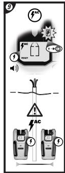
**Merk:** *Statiske, elektriske ledninger som kan utvikle seg bak gips og andre flater, sprer spenningsdeteksjonsområdet flere centimeter på hver side av den elektriske ledningen. Du kan hjelpe enheten med å finne ledningens posisjon, ved å holde enheten  $\frac{1}{2}$ " vekk fra veggen, eller ved å plassere den andre hånden på overflaten omrent 12" fra sensoren.*
