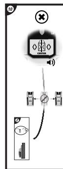
⑩ Ak sa pri stlačení aktivačného tlačidla všetky segmenty na LCD displeji bliknutím rozsvietia a zhasnú, premiestnite snímač Stud Sensor 200 na iné miesto a skúste to znova. Pustenie aktivačného tlačidla vypne snímač.
